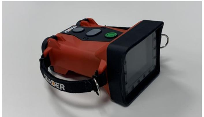
Eine Wärmebildkamera wandelt die Wärmestrahlung, die Objekte und Personen abgeben, in ein sichtbares Bild um. Die Möglichkeiten im Feuerwehreinsatz sind daher vielfältig und reichen vom Aufspüren von Bränden, Brandherden und Glutnestern bis hin zur Personensuche in allen möglichen Umgebungen. Der Einsatz kann so noch zielgerichteter, rascher und schonender für die Umgebung durchgeführt werden.
